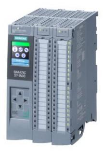
SIMATIC S7-1500 CPU compacte CPU 1511C-1 PN, unité centrale avec mémoire de travail 175 ko pour programme et 1 Mo pour données, 16 entrées TOR, 16 sorties TOR, 5 entrées analogiques, 2 sorties analogiques, 6 compteurs rapides, 4 sorties rapides pour PTO/PWM/sortie fréquence 1re interface: PROFINET IRT avec commut. 2 ports, 60 ns performance sur bit, incl. Connect. frontal push-in, SIMATIC Memory Card requise
