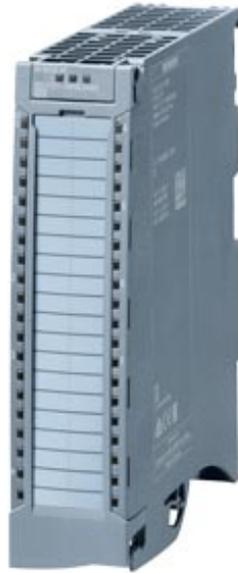
SIMATIC S7-1500, module d'entrées analogiques AI 8xU/I HF, résolution jusqu'à 24 bits, précision 0,1%, 8 voies dans des groupes de 1, tension de mode commun: 30V CA/60V CC, diagnostic; alarme de processus valeurs de mesure modulable, adaptation plage de mesure, calibrer en RUN livré avec élément d'alimentation, étrier de blindage et borne de blindage : Connecteur frontal (bornes à vis ou push-in) à commander séparément
