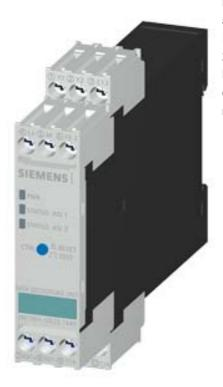
Module de découplage des données AS-i 2 x 4 A bornes à vis, AS-i double Module de découplage des données IP20, SlimLine S22,5 bornes à vis Largeur du module 22,5 mm IN: 24 V / 30 V CC OUT : 2 x AS-I, 4 A Protection contre les surcharges intégrée Détection des défauts à la terre intégrée contact de signalisation Téléréinitialisation
