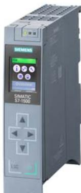
\*\*\* Pièce de rechange \*\*\* SIMATIC S7-1500, CPU 1513-1 PN, Module unité centrale avec 300 Ko de mémoire de travail pour le programme et 1,5Mo pour les données, 1. interface : PROFINET IRT avec commutateur 2 ports, performance sur bit 40 NS, carte mémoire SIMATIC nécessaire
