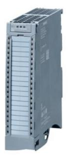
SIMATIC S7-1500, module d'entrées analogiques AI 8xU/R/RTD/TC HF, résolution 16 bits, jusqu'à 21 bits résolution pour RTD et TC, précision 0,1%, 8 voies dans des groupes de 1, tension de mode commun: 30V CA/60V CC, diagnostic; alarme de processus modulable plage de mesure de température, thermocouple type C calibrer en RUN livré avec élément d'alimentation, étrier de blindage et borne de blindage : Connecteur frontal (bornes à vis ou push-in) à commander séparément
